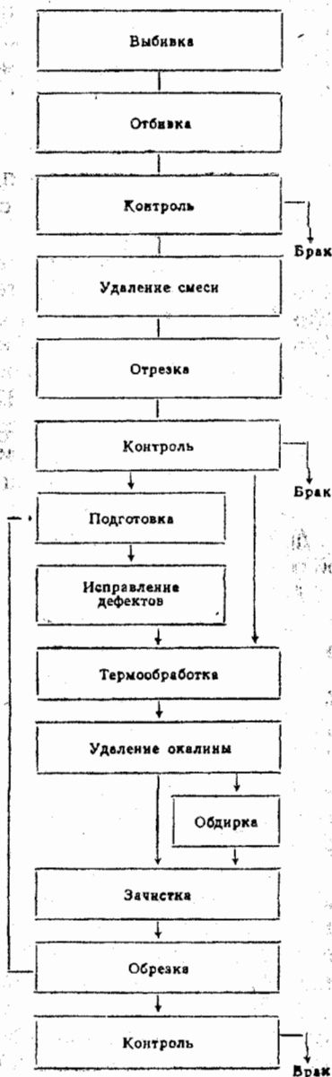
Рис. 3.5.1. Схема процесса очистки чугуновых и стальных отливок
